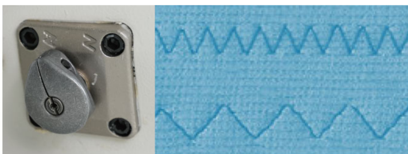
二點 / 四點切換旋鈕 1-step / 3-step Pattern Switch
